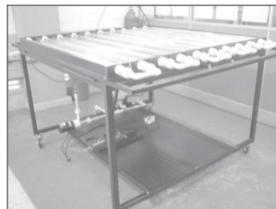
Foto 6 Foto-reactor cilíndrico parabólico compuesto (CPC)
