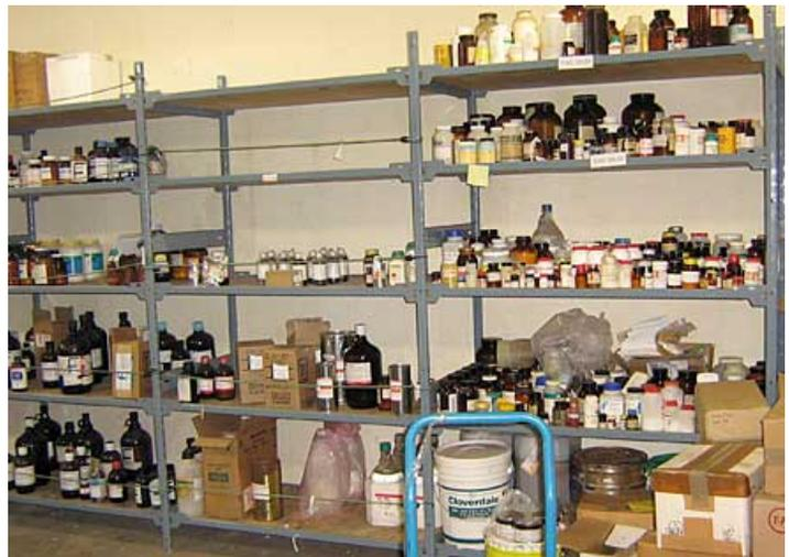
Figura N° 2 Almacenamiento inadecuado de sustancias químicas ignorando las incompatibilidades. En caso de incendio, caídas, roturas o cualquier otro tipo de incidente, los envases o recipientes pueden resultar dañados y como consecuencia los productos contenidos pueden entrar en contactos entre sí produciendo reacciones peligrosas.
