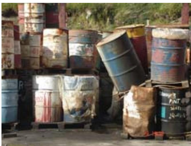
Foto N° 7 Almacenamiento inadecuado de residuos peligrosos
